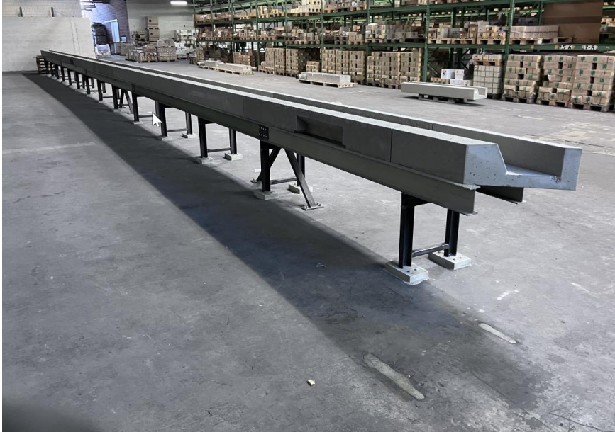
Rohlinge der Fertigbauteile aus Carbon-Beton im Werk ©agrob-buchtal.de
